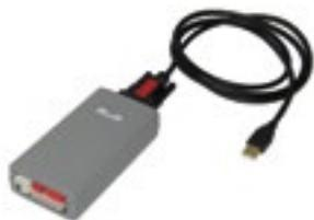
SIB (Serial Interface Board) es el dispositivo utilizado para memorizar y transferir actualizaciones de firmware a los sistemas de pago Paytec en el campo. El firmware se carga con anterioridad en el dispositivo desde un ordenador con el software PC Configurator. Con EAGLE, FOUR, Giody, Caimán y Caimán Lite, SIB sirve también para actualizar la configuración.
