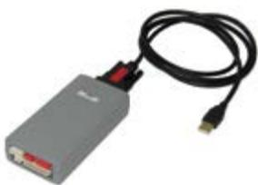
SIB (Serial Interface Board) è un dispositivo utilizzato per memorizzare e trasferire il firmware ai sistemi di pagamento Paytec sul campo. Il firmware viene precedentemente caricato sul dispositivo da un PC con il software PC Configurator. Con Eagle, Four, Giody, Caiman e Caiman Lite, SIB serve anche per aggiornarne la configurazione.
