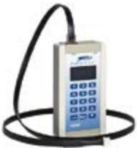
Der tragbare Programmierer P6000 ist der natürliche Nachfolger des P3000. Zahlreiche Verbesserungen wurden in Bezug auf Kompaktheit, Kapazität, Geschwindigkeit, Sichtbarkeit und Ergonomie vorgenommen. Die Produktprogrammierung erfolgt über ein Kabel, das an die serielle Schnittstelle der Produkte angeschlossen ist.
